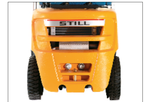
Contrapeso e saída de ar
